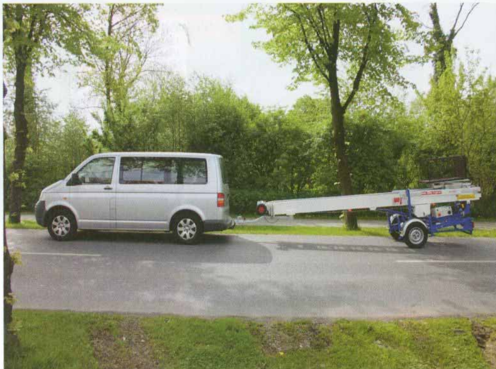
Einzigartig ist immer noch der Klaas-Anhängerkran. Mit einem Gewicht von 3,5 t erfüllt er sowohl alle wesentlichen Kranfunktionen als auch die Funktionen einer Hubarbeitsbühne.
