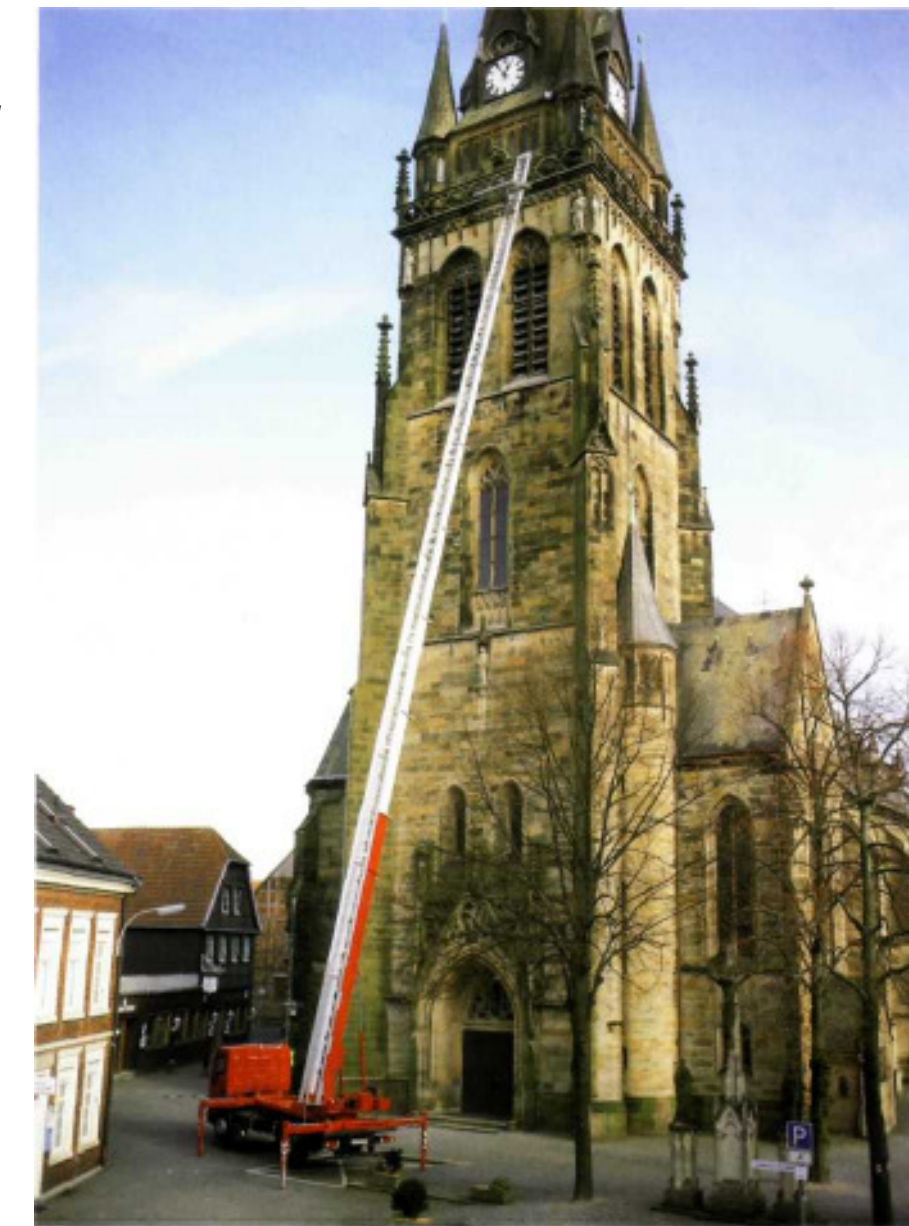
Mit einer Arbeitshöhe von bis zu 64 m ist der Klaas HV64 einer der leistungsstärksten Möbelaufzüge, aufgebaut auf einen 121 LKW, weltweit.
